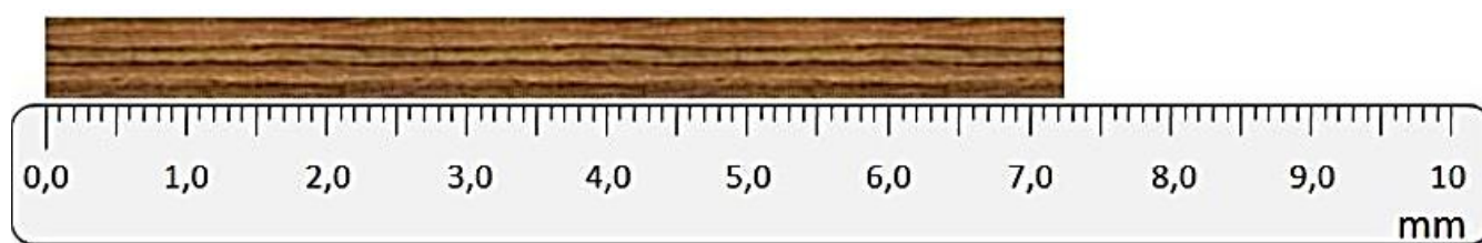
Medición directa de un objeto realizada con una regla graduada en milímetros. Fuente: (Pérez & Weigandt, 2013)
